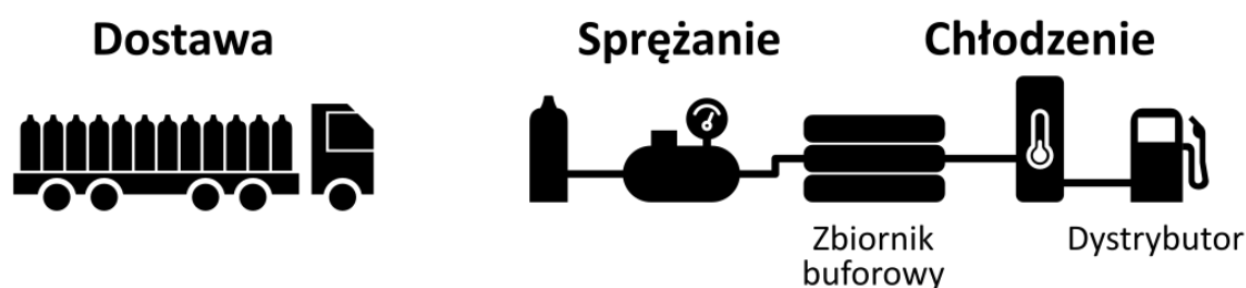
Rysunek 4. Proces dostawy wodoru na stację tankowania
