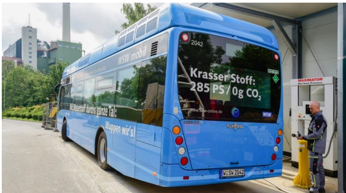
Rysunek 3. Tankowanie autobusu elektrycznego z wodorowymi ogniwami paliwowymi w Wuppertal
